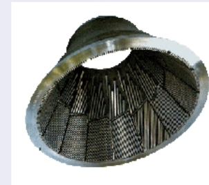
Refiner: Stator (äußeres Kegelmesser)
