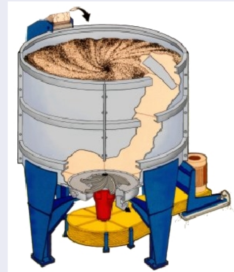
Pulper: schematische Darstellung
