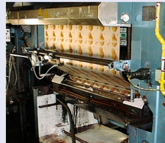
Kochsiek Rotationstiefdruck- maschine ca. 1985
